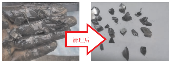
图9 发电机轴承内部碎屑
